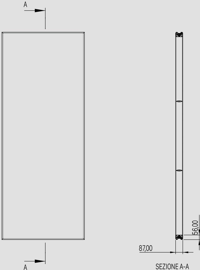
**STRUTTURA:** Struttura portante in estruso di alluminio sui 4 lati.
