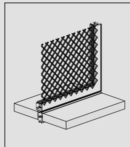
**DESIGN DELLA LAMIERA STIRATA:** possibilità di scegliere lamiere trasparenti e ombreggianti diverse tra loro grazie alla conformazione geometrica delle maglie.
