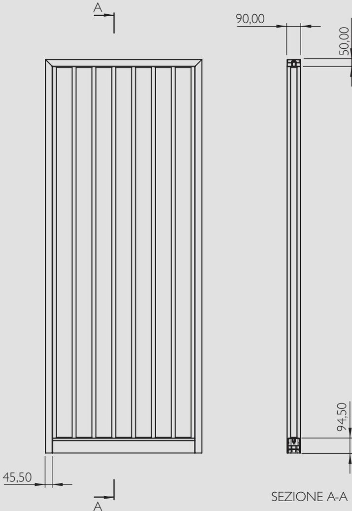
**STRUTTURA:** struttura portante in estruso di alluminio sui 4 lati.
