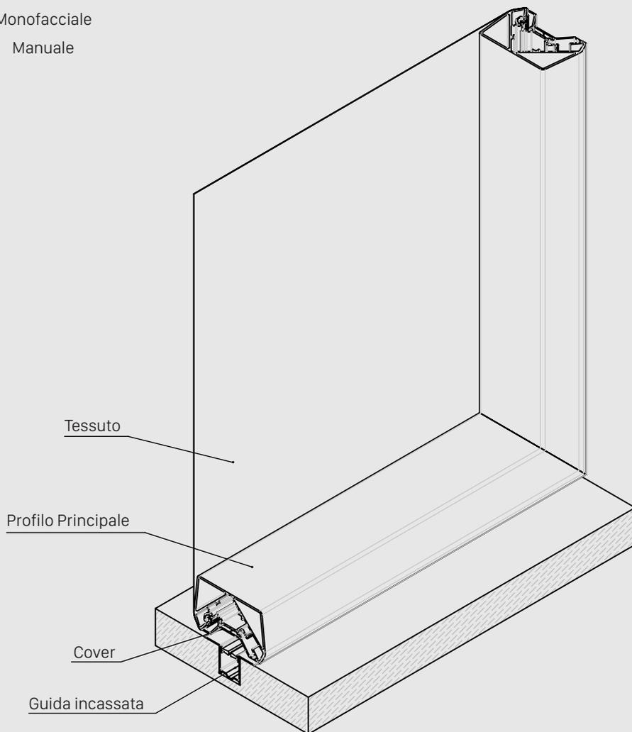
**OSCURAMENTO PERPENDICOLARE:** da 100% a 20% (a seconda del tessuto utilizzato).
