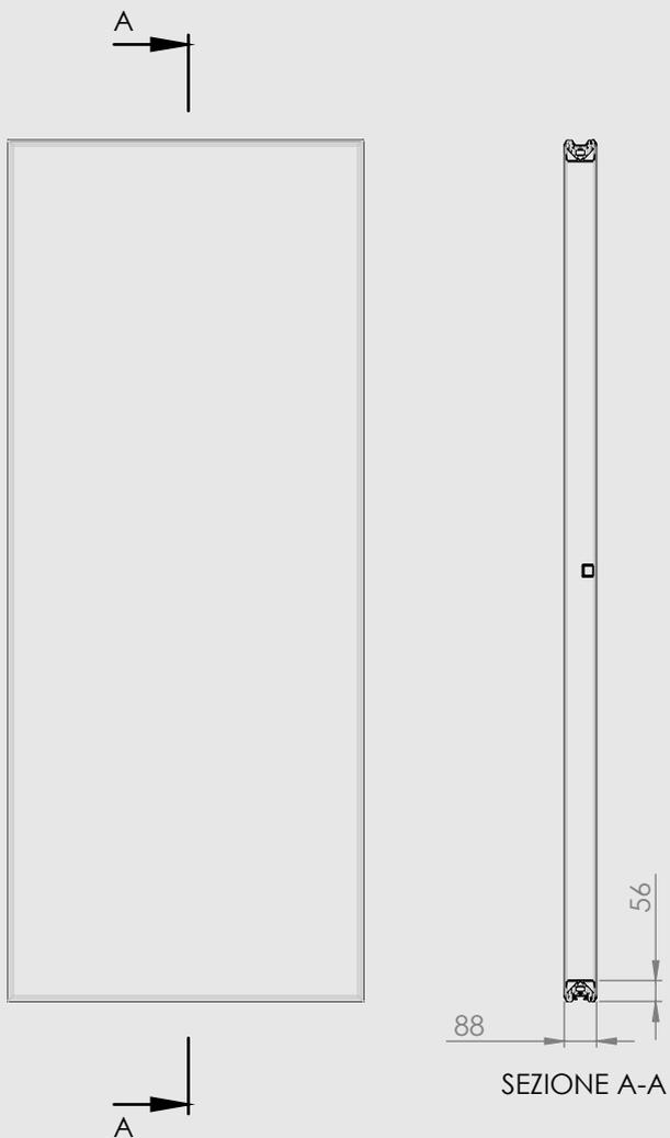
**STRUTTURA:** Struttura portante in estruso di alluminio sui 4 lati.
